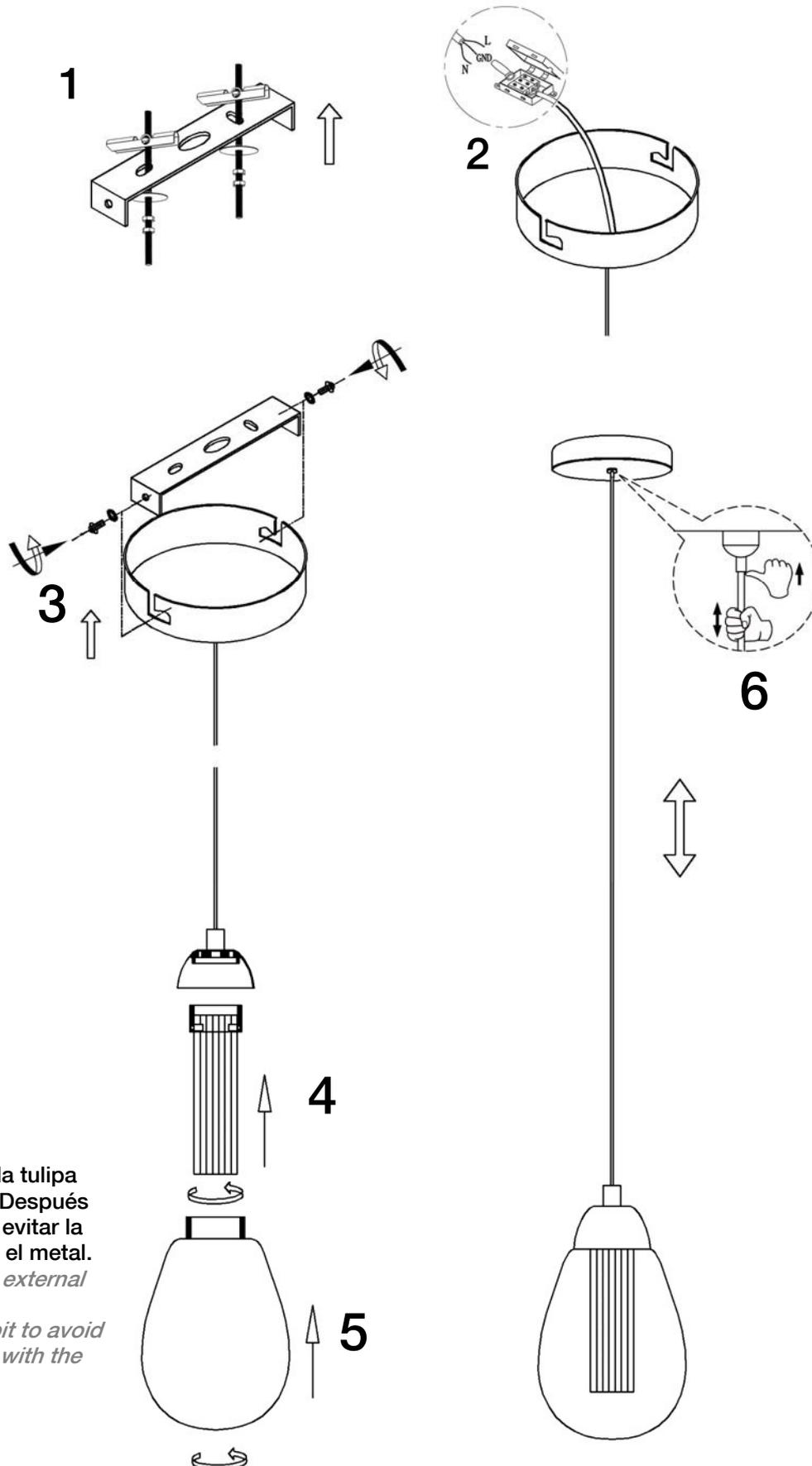
**ATENCIÓN:** Enroscar la tulipa exterior hasta el final. Después aflojarla un poco para evitar la presión del cristal con el metal.
