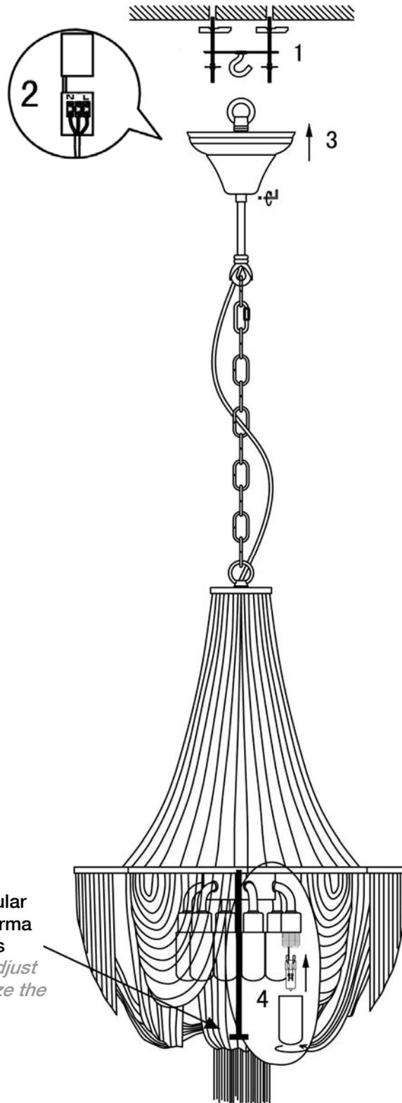
El cable tensor permite regular la altura y personalizar la forma del recogido de las cadenas
