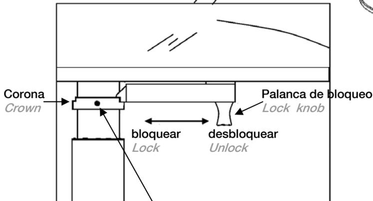
Para el bloqueo exacto de la tapa de cristal, aflojar los dos tornillos de la corona y ajustarla a la izquierda hasta su tope.
