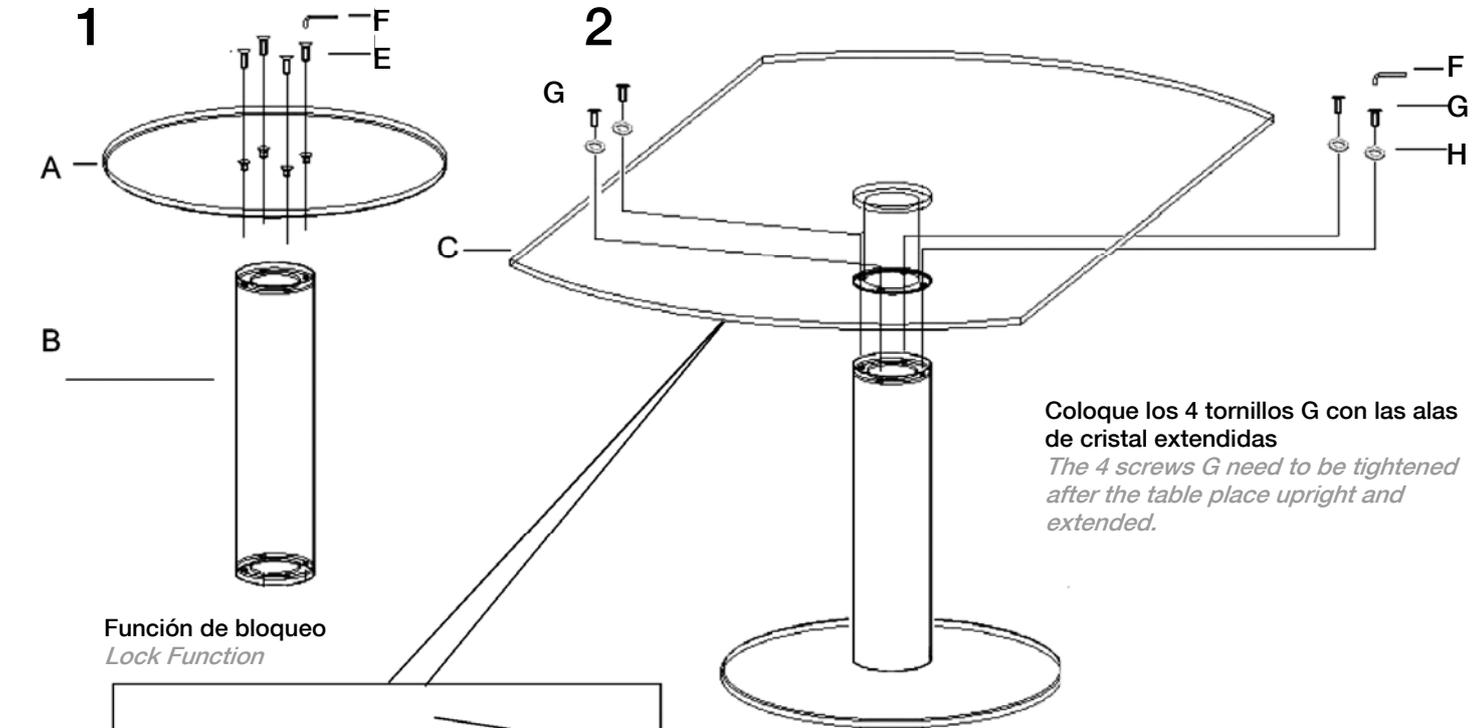
Coloque los 4 tornillos G con las alas de cristal extendidas
