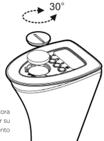
Retirar la banda protectora de las pilas para permitir su conexión y funcionamiento de las mismas.
