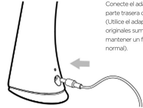
Conecte el adaptador en la parte trasera de la lámpara. (Utilice el adaptador y enchufe originales suministrados para mantener un funcionamiento normal).
